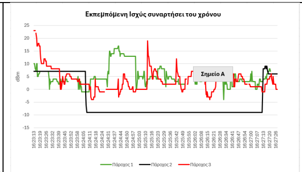
Εικόνα 7: Εκπεμπόμενη ισχύς συναρτήσει του χρόνου στο Σημείο Α (κοντά στο παράθυρο)
